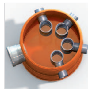
Zpomalovací šachta s usazovacím prostorem. Použity jsou odbočky KGEA s úhlem 87 ° 30'.
