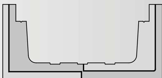
Káblový žľab s vloženým krytom
